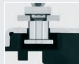
Achtkant-Sicherheitsverschlussbolzen im Sicherheitsschließblech fest verankert
